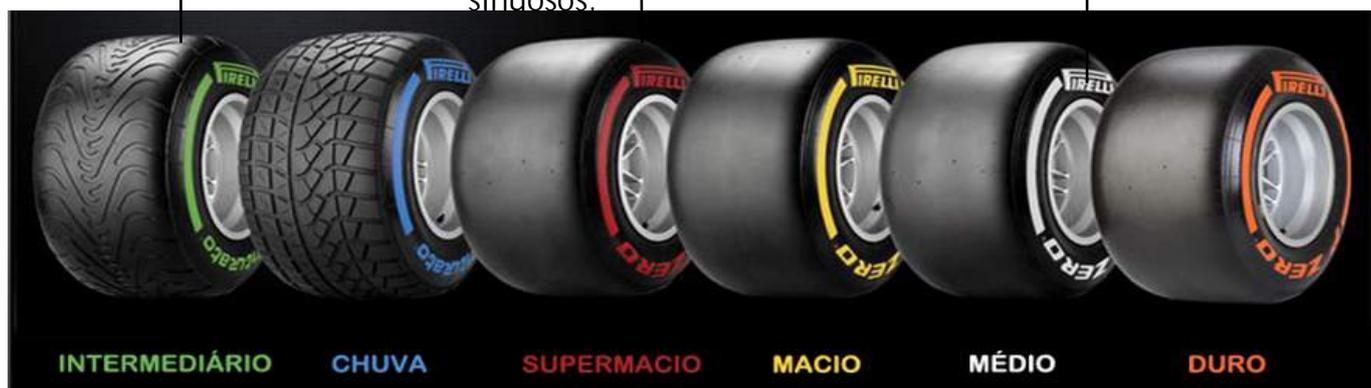
**Pneus para chuva:** Estes são usados em pistas muito molhadas. Estes pneus conseguem evacuar 60 litros de água por segundo na sua velocidade máxima.
